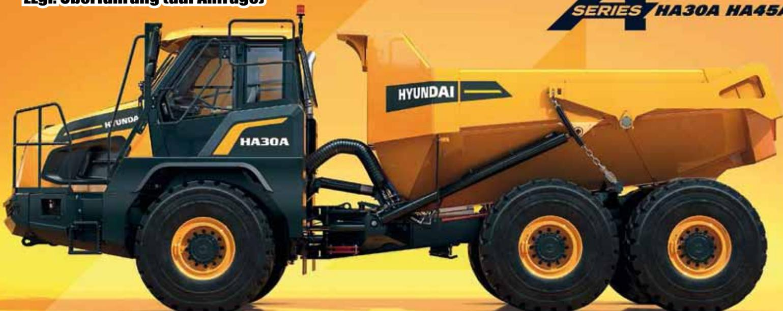
Permanenter 6-Rad-Antrieb, Tandem-Hinterachse und das vorne angeordnete Drehwerk sorgen für eine gleichmäßige Kraft- und Gewichtsverteilung und damit optimale Betriebsleistung. Der geneigte hintere Rahmen leitet die Last zur Maschinenfront, was die Traktion verbessert und für einen tiefen Schwerpunkt und damit bessere Stabilität und schnelles, einfaches Anheben der Mulde und damit maximale Produktivität sorgt.
