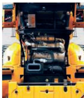
Die **aufklappbare Motorhaube ist komplett einziehbar und elektrisch zu öffnen**, für leichten Zugang zum abgedichteten Motorraum und Kühler. Die Brandgefahr im Motorraum durch zufließende Fremdmaterialien wurde eingedämmt.
