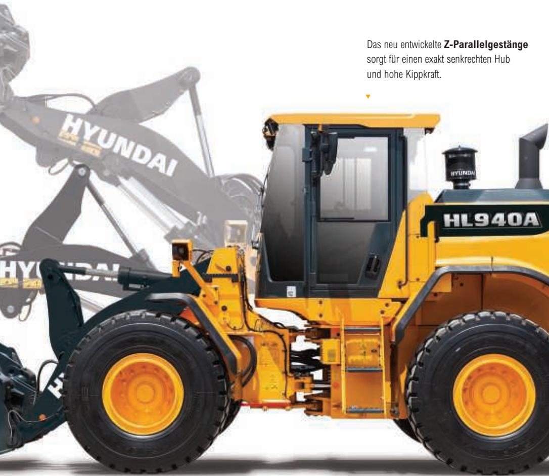
Das neu entwickelte **Z-Parallelgestänge** sorgt für einen exakt senkrechten Hub und hohe Kippkraft.
