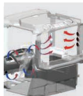
Die **Klimaanlage** ist an der rechten Kabinenseite angeordnet, was die Wartung und Filterwechsel vereinfacht. Sie enthält einen Hochleistungs-Innenfilter mit einem speziellen, besonders leistungsfähigen Filtermaterial.
